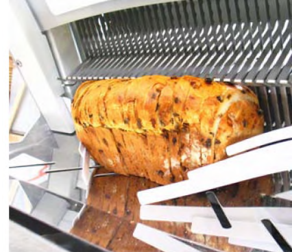
Once cut the slices are held in place by flaps Nach dem Schneiden werden die Schnitten durch Klappen gehalten.
